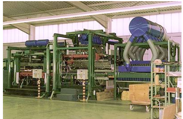
Biegestrecke mit Abkühlung
