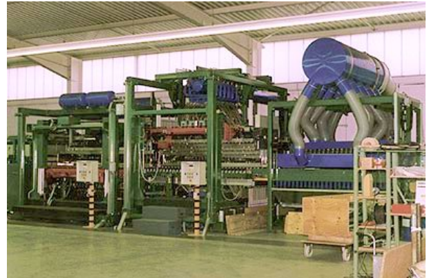
Biegestrecke mit Abkühlung
